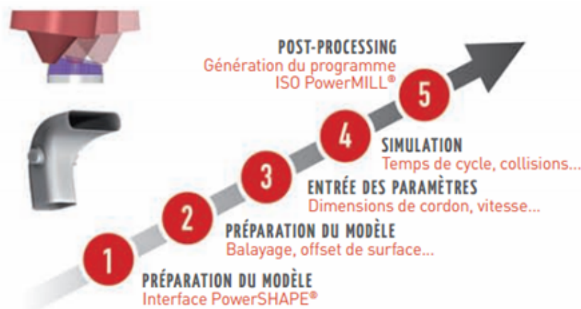
FIGURE 22 – Génération de trajectoires d'usinage à l'aide de PowerCLAD
